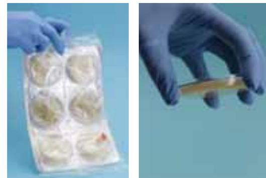
Abbildung 3. TSA Kontaktplatten in der Blisterpackung (Best.-Nr. 271114ZI). Das Medium wird auf eine Oberfläche gedrückt, um eine Probe zu nehmen. Die spezielle Blistereinzelpackung ermöglicht die Verwendung nur einzelner Platten.
