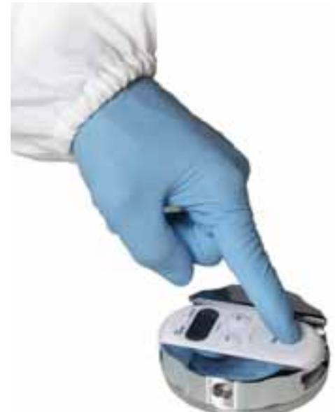
Kontaktplatten-Applikator zur Standardisierung des Anpressdrucks der Kontaktplatte (Best.-Nr. 710-0961).
